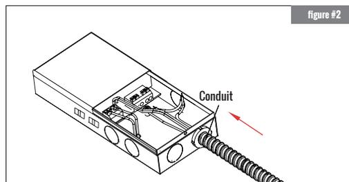
2. Connectez le conduit électrique à la boîte électrique.
