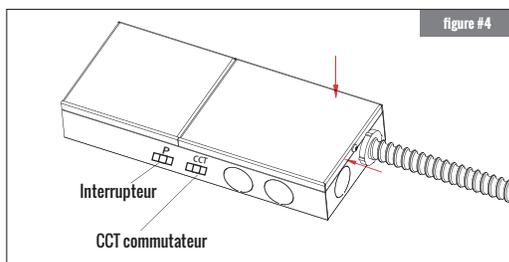
4. Remettez le couvercle du boîtier électrique en place et fixez-le avec une vis. Sélectionnez la puissance et la température de couleur réglables.
